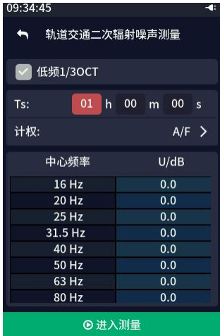
图 6-4-7-1 轨道交通二次辐射噪声测量
